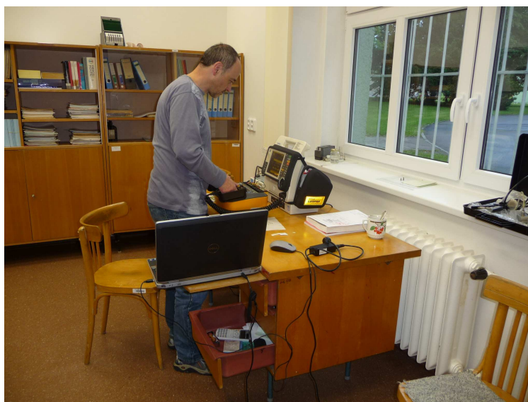
Obr. 1: Revizní technik CZdrM při kontrole technického stavu defibrilátoru
