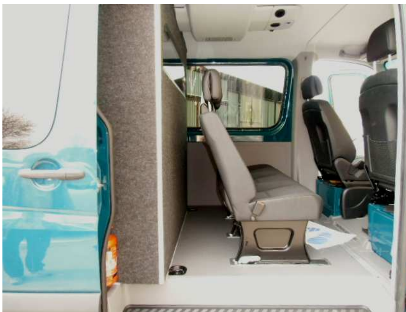
Obr. 1: Prostor pro 5 členů posádky oddělený pevnou přepážkou
