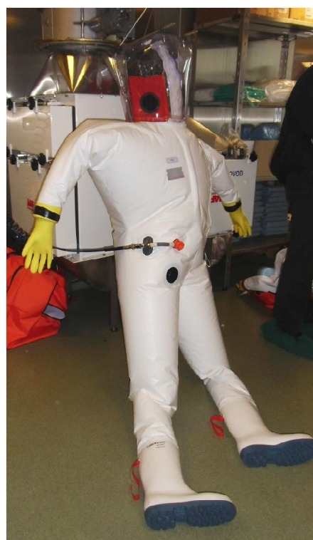
Obr. 13: Tlakový test těsnosti obleku
