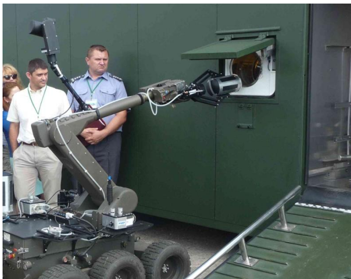
Obr. 2: Polský dálkově řízený mobilní robot pro odběr vzorků z prostředí
