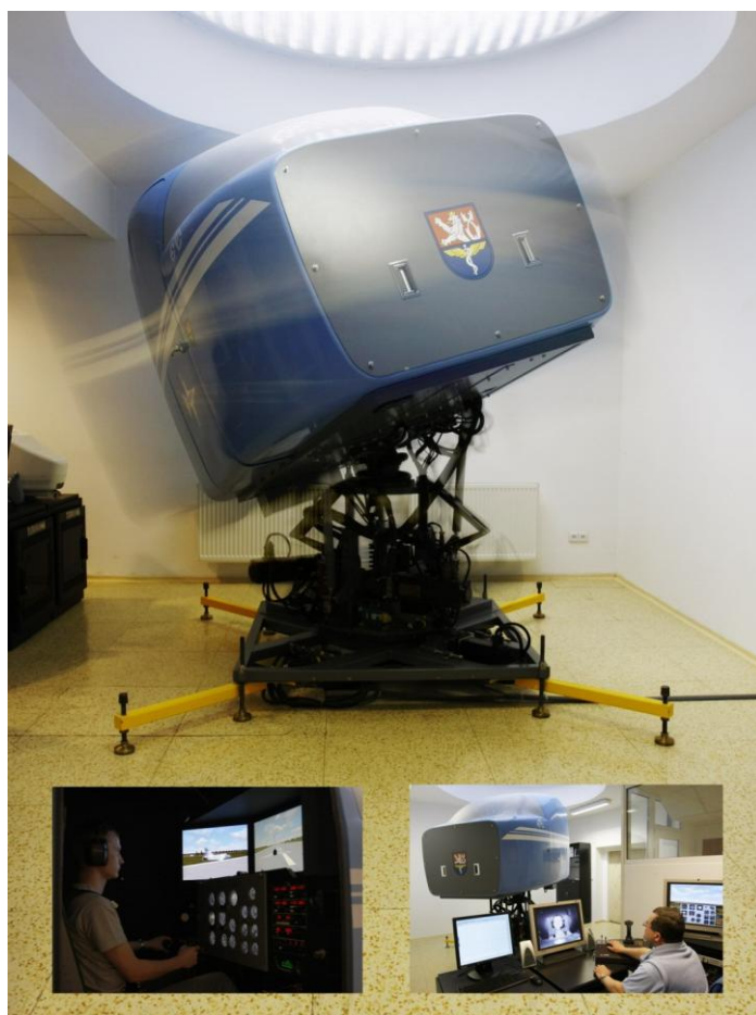
Obr. 4: Výcvik v dezorientačním simulátoru GYRO II IPT
