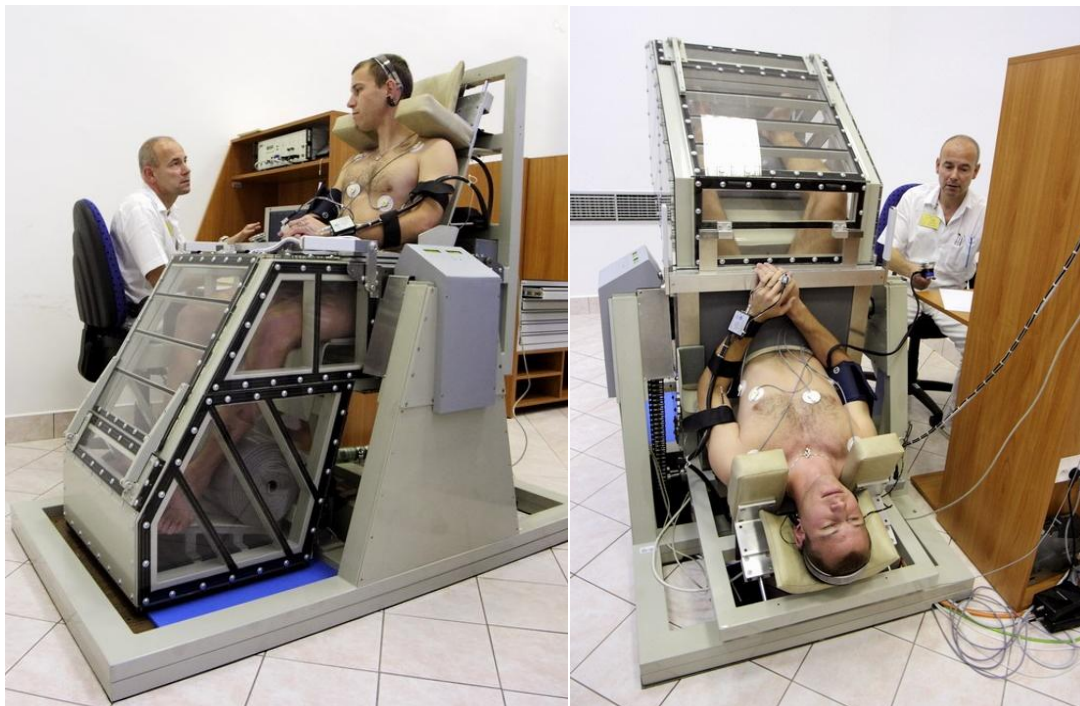
Obr. 2 a 3: Testování odolnosti vůči +Gz přetížení metodou LBNP
